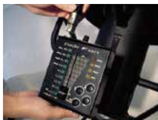
Блок управления для ручной, DMX или программной настройки.
